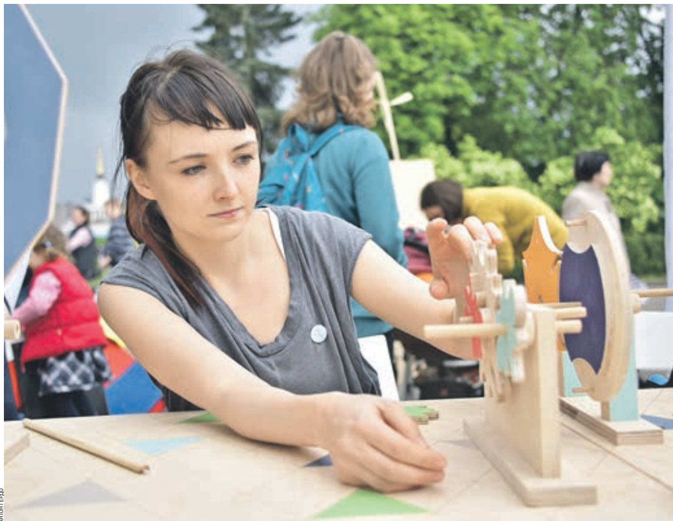
21 мая 2016 года 13:40 Столяр столярной мастерской Дарья Сорокина собирает часть механизма с «непорядочными шестернями». Они так называются из-за нестандартной формы и разного расстояния между зубцами
