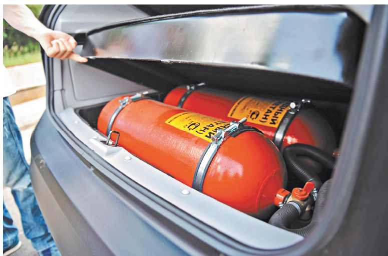
Баллоны занимают весь багажник? Надо было устанавливать тороидальные. Они могут размещаться на месте для запасного колеса. Впрочем, каждый выбирает по себе: либо много проехать, либо много перевезти.
