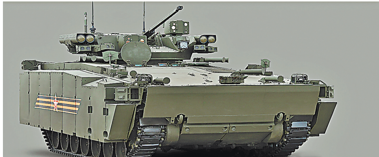
Боевая машина пехоты «Курганец-25». Имеет ракетно-пушечное вооружение. От вражеских ракет и снарядов прикрыта комплексом активной защиты.
