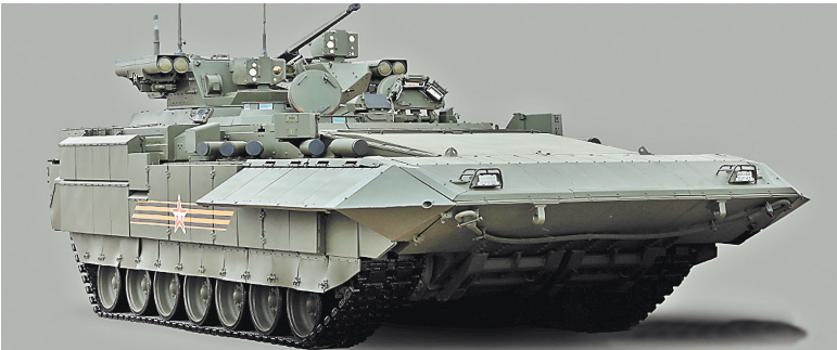
Тяжелая БМП Т-15. Имеет танковую по толщине броню, комплексы активной и динамической защиты. Вооружение — 30 мм пушка и четыре ПТУРСа.
