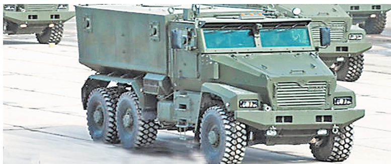
Бронированный грузовик «Торнадо-У», созданный на базе автомобиля «Урал». Отличается хорошей броневой защитой и устойчивостью к минным подрывам.
