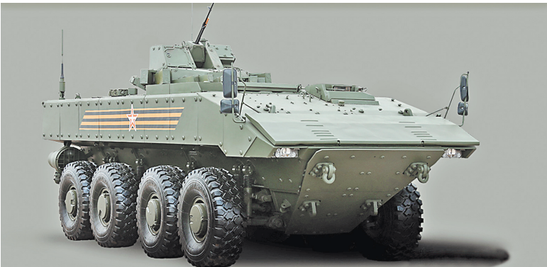
Бронетранспортер «Бумеранг». Корпус имеет конструктивную противоминную устойчивость. Выход десанта — через кормовую аппарель. Двигатель — спереди.
