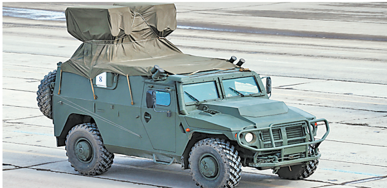
Бронированный автомобиль «Тигр» с комплексом управляемого ракетного вооружения, способного поражать бронетехнику, беспилотники и вертолеты.
