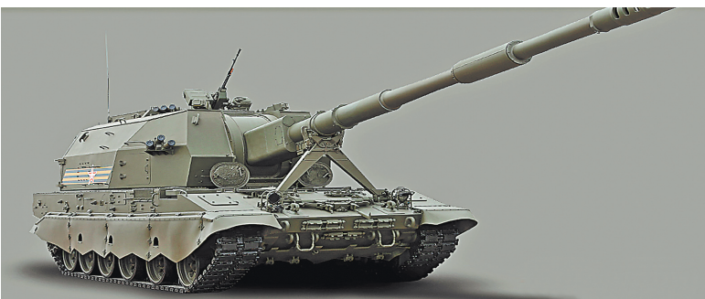
Самоходная 152 мм пушка «Коалиция-СВ» сменит самоходку «Мста-С». На ней стоит более точная пушка, новейший комплекс навигации и управления огнем.
